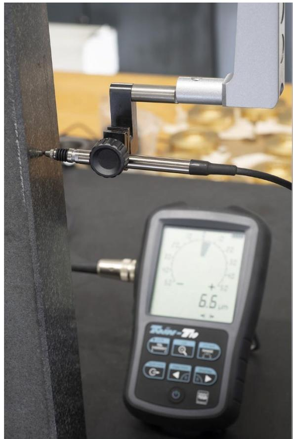
Sobald der Halteschlitten blockiert worden ist, kann die Montage der Tasterhalterung wie (zum Beispiel) auf unten abgebildetem Foto durchgeführt werden.
