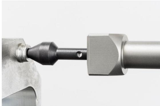
Diese Funktion wird häufig für kegelförmige Taster verwendet, um den Abstand zwischen kleinen Bohrungen zu messen, bei denen die direkte Messung (über ihre Umkehrpunkte) aufgrund der geringen Abmessung schwierig ist.
