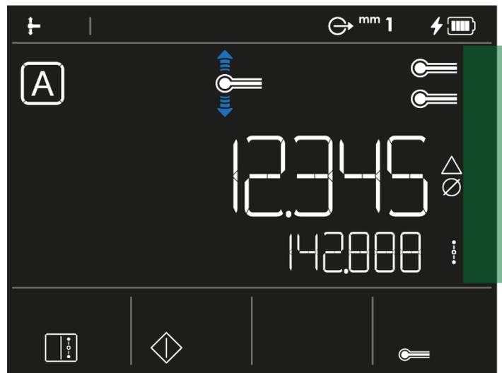
Während des Antastvorgangs steigt ein Balken auf und ab. Je nach Verlauf ändern die angezeigten Vierecke ihre Farbe. Die Farben entsprechen der auf den Messeinsatz (und damit auf den Messschlitten) ausgeübten Kraft:
