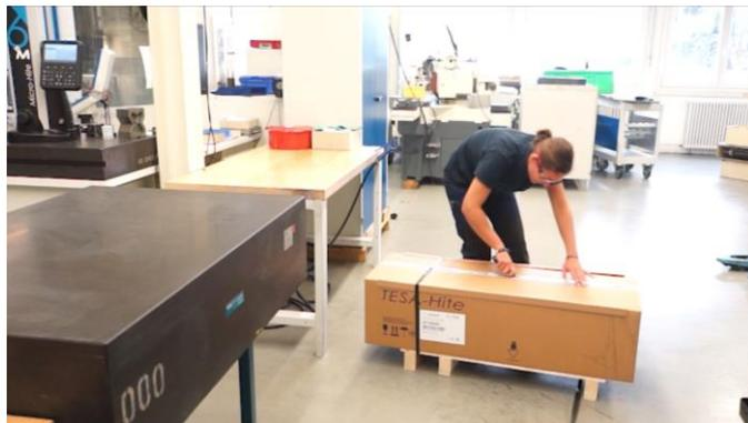
3. Entfernen Sie den Schaumstoffblock, in dem das Zubehör gelagert wird, von der Palette und legen Sie ihn auf die Hartgesteinsplatte.
