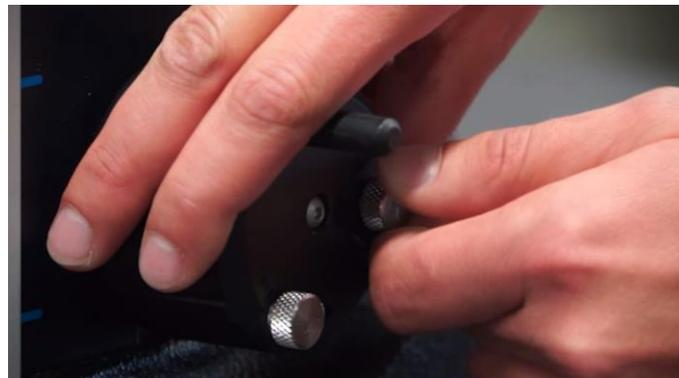
25. Positionieren Sie den Aufnahmezapfen des Messeinsatzhalters in einer bequemen Höhe, um das Zubehör zu montieren und blockieren sie den Schlitten wieder.
