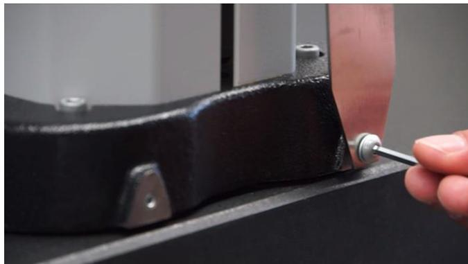
21. Entfernen Sie die Haltevorrichtung, indem Sie sie vorsichtig über den Schaumstoff um den Aufnahmezapfen des Messeinsatzhalters schieben.
