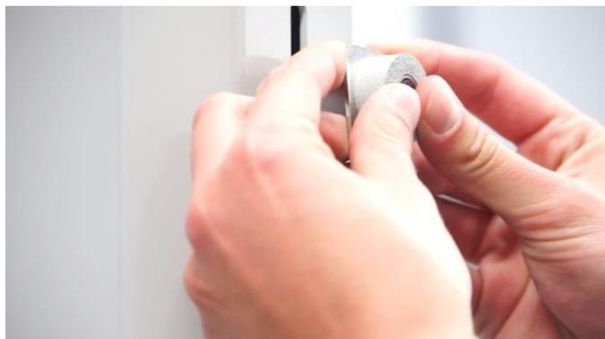
22. Entfernen Sie den Schaumstoff um den Aufnahmezapfen des Messeinsatzhalters.
