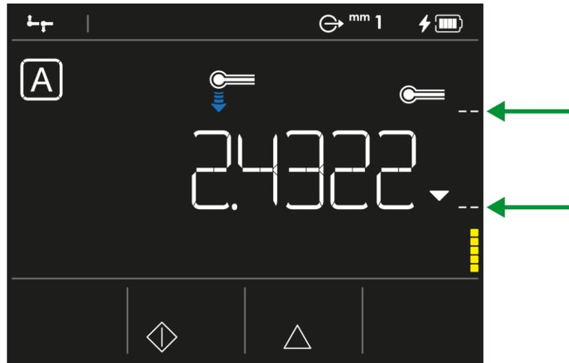
Der untere Strich entspricht bei einer Messung mit dem Messeinsatz nach unten dem zum Erfassen des Antastens mindestens erforderlichen Druck. Wenn der Druck nicht ausreicht, ist der Balken gelb. Nach dem horizontalen Strich wird der Balken grün oder sogar rot, wenn der ausgeübte Druck sehr stark ist.
