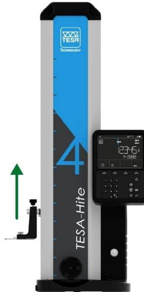
2. Sobald der Anschlag erreicht wurde, weiter leicht am Verstellrad in dieselbe Richtung drehen
