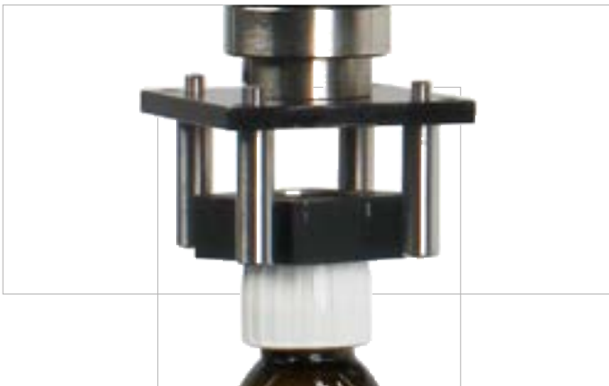
Prüfen eines Kindersicherheitsverschlusses
