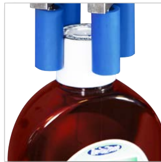
Prüfen eines Kindersicherheitsverschlusses
