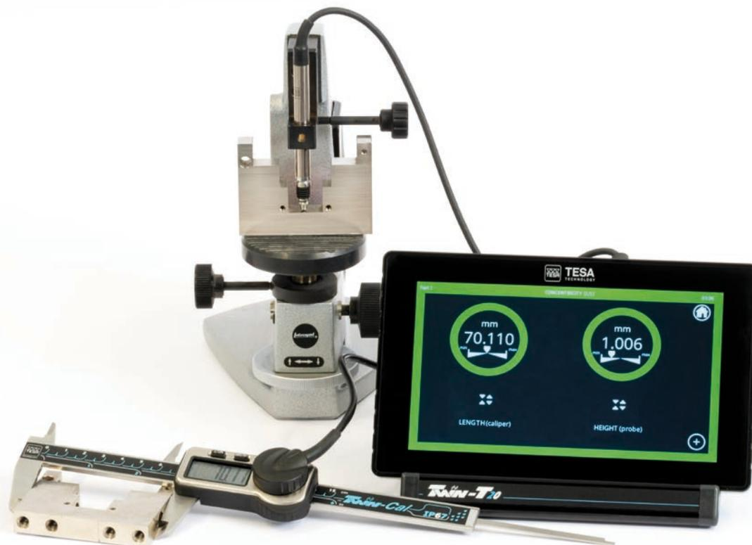
Kontrolle zweier Funktionsmesswerte, mit einem induktiven TESA-Messtaster und einem Messschieber (beide an die Anzeige angeschlossen).
