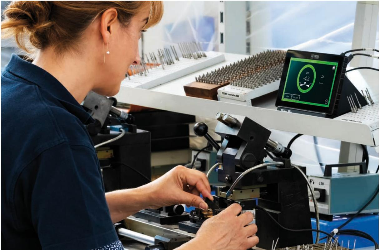
Rundlaufmessung vor der Montage zylindrischer Teile
