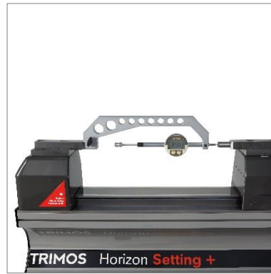
Prüfen von Messuhren und Feinzeigern ( von 50mm) (TA-IH-301)
