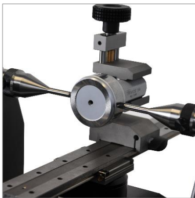
Prüfen von Lehdornen und Prüfstiften ( bis \varnothing 100mm, Länge 280mm) (TULM6/L0.5, LABC15)
