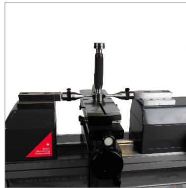
Prüfen von Gewinde-Lehrdornen (ab M100) (TA-SU-313, TEL6, 3P/0.17-3.2/S6.5)
