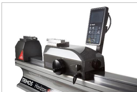
Blockierung des Messschlittens und Feinverstellung
