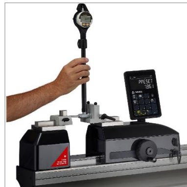
Manuelles Einstellen von 2-Punkt-Bohrungsmessgeräten (TA-SU-301, TEL5)
