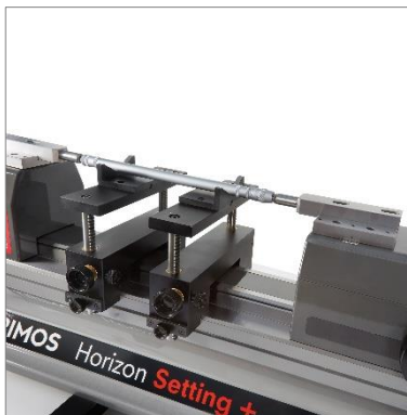
Prüfen und Einstellen von 2-Punkt-Innen-Vergleichsmessgeräten (TELMA7)
