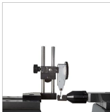
Prüfen von Fühlhebelmessgeräten (TULM 15.1, TEL5)
