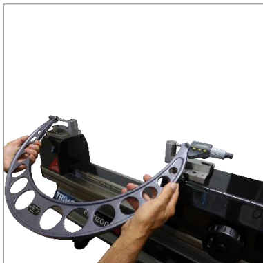
Manuelles Prüfen großer Bügelmessschrauben (TEL5) (TEL11)
