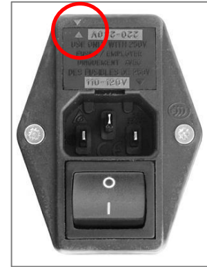
Spannungswähler ist auf 220-240 V gesetzt
