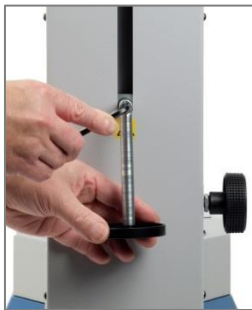
Gewicht-Auflage befestigen Zusätzliche Gewichte anhängen Gewicht für Aufliegelast ablegen
