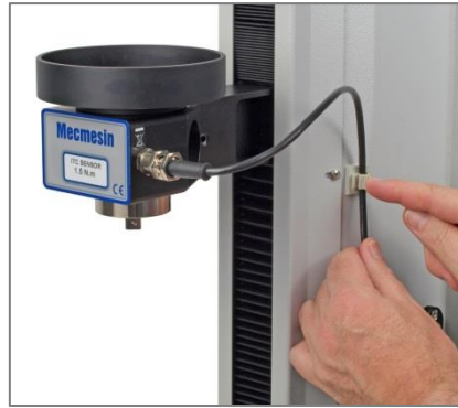
sichern Sie das Kabel und verstellen Sie die freie Länge
