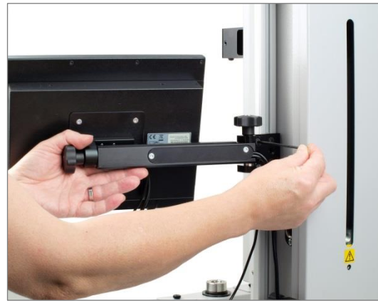
Die obere Torx-Schraube als Erstes anziehen
