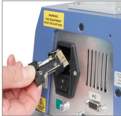
Kartusche entfernen, Sicherung ersetzen
