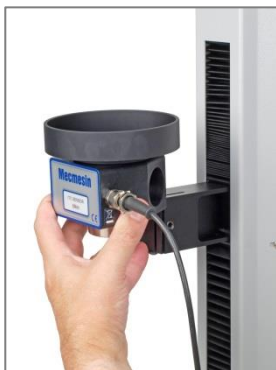
Schieben Sie den HTC an der ... Schwalbenschwanzhalterung
