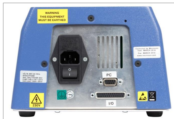
Rückwand von einem Helixa. Stecken Sie das USB-Kabel in die PC-Steckdose, die mit ‚PC‘ beschriftet ist.
