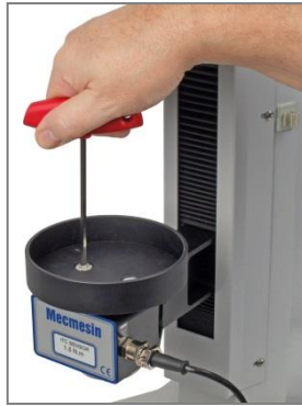
Anbau der oberen Gewicht-Ablageschale auf dem Drehmomentsensor
