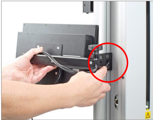
Höhenlage der Konsole justieren
