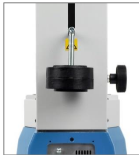
Gewicht-Auflage befestigen Zusätzliche Gewichte anhängen Gewicht für Aufliegelast ablegen
