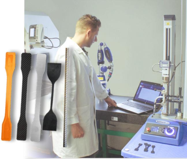
Die ELS ist in 10 Messkapazitäten von 2,5 N bis 2,5 kN erhältlich. Mit einer außergewöhnlichen Genauigkeit von  $\pm 0,5\%$  des angezeigten Werts bietet die ELS die zusätzliche Präzision, die für anspruchsvollere Materialprüfanwendungen erforderlich ist.
