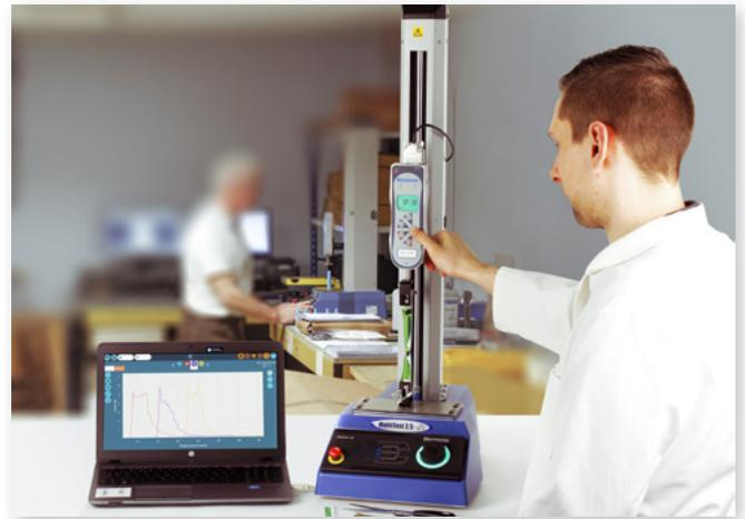
Die beliebteste Konfiguration ist die Kombination aus MultiTest-dV und AFG. Diese ist ideal für einfache Zug- und Druckanwendungen, bei denen **die Erfassung eines Spitzenlastwerts erforderlich ist**.
