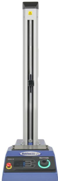
◀ **MultiTest 2.5-dV** für Zug- und Druck- Anwendungen bis 2,5 kN; die ideale Wahl für viele verschiedene Routinetests.
