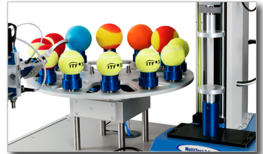
Tennisball-Vorrichtung, auf einem Mecmesin Prüfgerät
