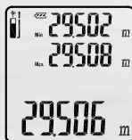
Măsurarea continuă a distanței cu valoare minimă și maximă.
