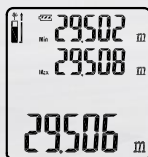
Continue afstandsmeting met minimum- en maximumwaarde.
