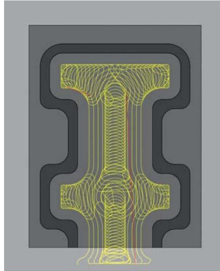
Neue CAD/CAM-Programmiersysteme ermöglichen eine Bearbeitung komplexer Konturen und Taschen in 2D und 3D mit einem Trochoidal-Fräszyklus. Ziel dieser neuen Zyklen ist eine möglichst effektive Berechnung der Fräsbahnen, um Leerwege zu verhindern.
